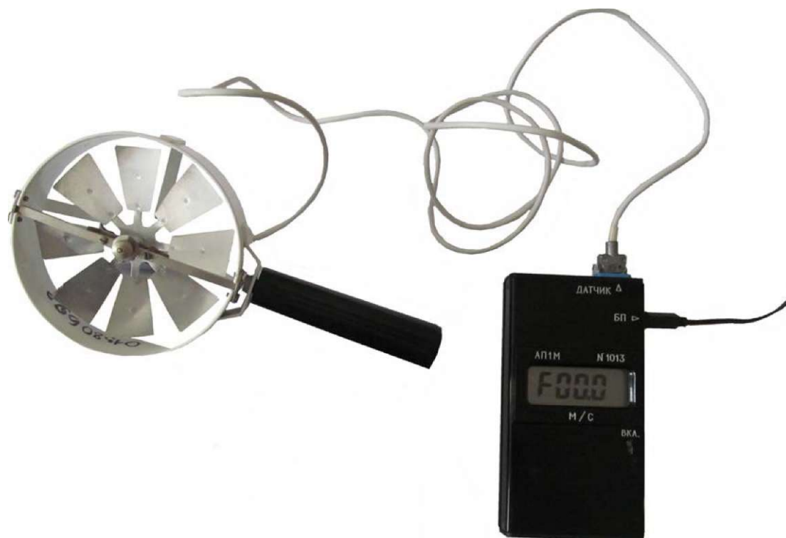
1 - пульт измерительный; 2 - первичный преобразователь с крыльчатым ветроприемником
