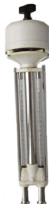
Рисунок 3 - Аспирационный психрометр (Ассмана)
