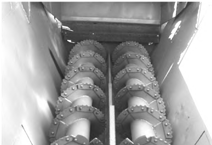
Рисунок 5 – Кормораздатчик ИСРК-12Ф: смешивающе-измельчающие шнеки
