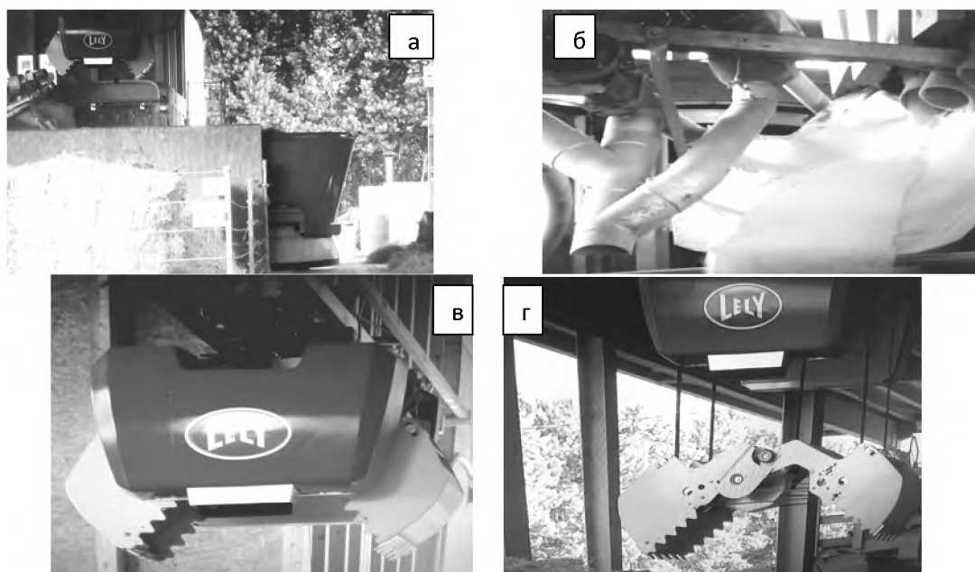
а – кормовая кухня Lely Vector; б – загрузка жидких кормов; в, г – работа грейферного загрузчика
