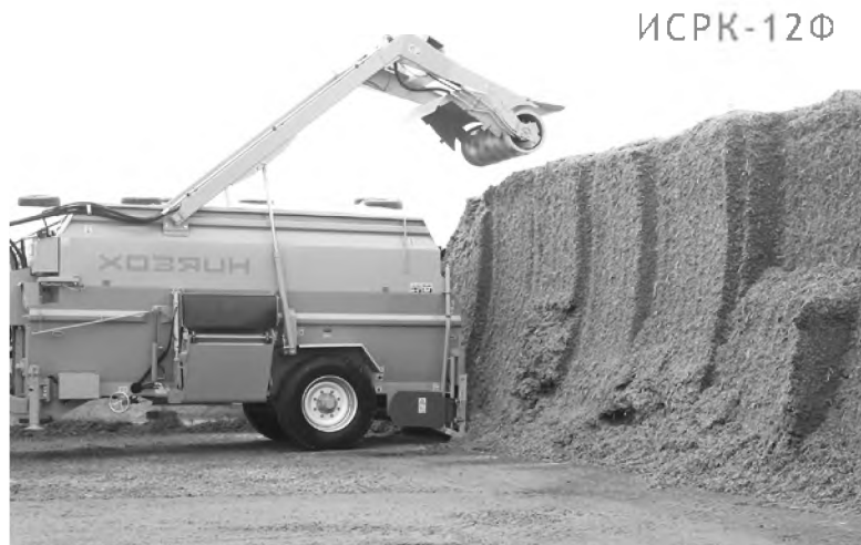
Рисунок 7 – Технологический процесс загрузки кормов фрезой ИСКРК-12Ф
