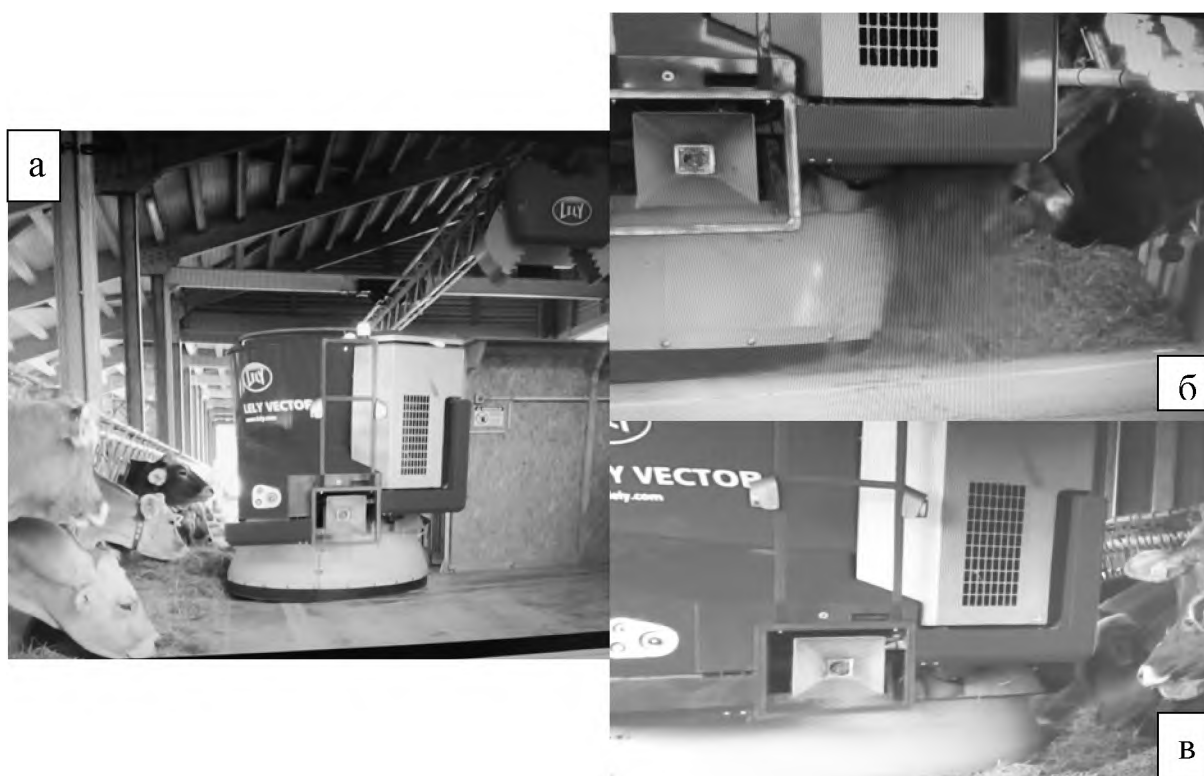
Рисунок 26 – Работа Lely Vector на этапах смешивания и раздачи кормосмеси
