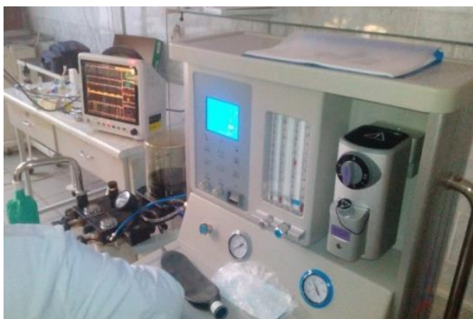
Рисунок 2 - Монитор пациента и аппарат для ингаляционной анестезии
