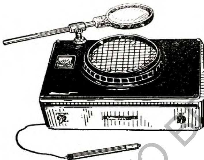
Рисунок 22 - Прибор для подсчета колоний бактерий типа ПСБ (по Карташовой А. Н.)
