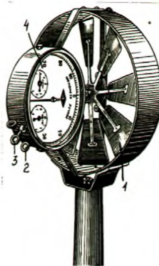
1 - крыльчатка (ветроприемник); 2 - ушки; 3 - арретир; 4 - шкала Рисунок 14 – Анемометр крыльчатый (по Карташовой А. Н.)
