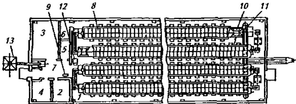
1 – помещение для содержания кроликов; 2 – служебно-бытовое помещение; 3 – вентиляционная камера; 4 – помещение для инвентаря и подстилки; 5 – помещение для кормов; 6 – электрощитовая; 7 – коридор; 8 – батарея клеточная ОКФ-1-01.000; 9 – тележка для перевозки кроликов ОКФ-1-03.000; 10 – механизм пометный скребковый МПС-4М; 11 – транспортер скребковый КНЦ-7-12; 12 – тележка для перевозки кормов БЦМ -90-10А; 13 – бункер для сухих кормов БСК-10
