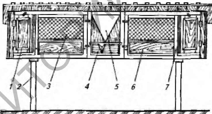
1 – дверка в гнездовое отделение; 2 – столик-подставка; 3 – сетчатая дверка; 4 – откидная поилка; 5 – откидная кормушка; 6 – ясли для грубых кормов; 7 – ось кормушки
