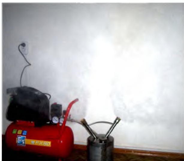
Рис. 18-19 – Генератор аэрозолей САГ Схематическое устройство и принцип работы аэрозольного генератора САГ
