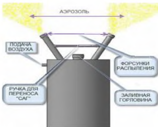
Рис. 18-19 – Генератор аэрозолей САГ Схематическое устройство и принцип работы аэрозольного генератора САГ
