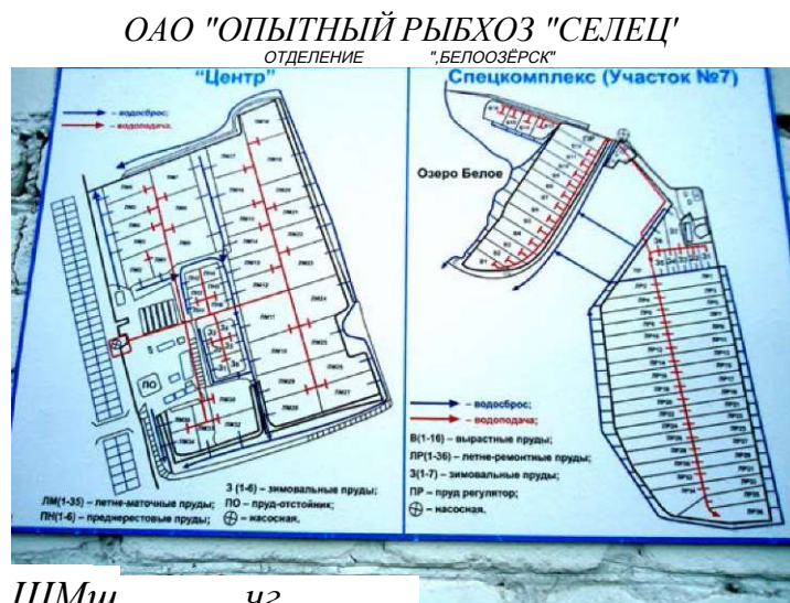
Рисунок 46 - Схема водоподающей и водосбросной системы
