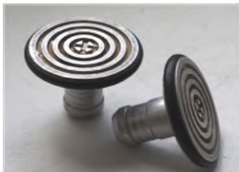
Рисунок 4.1.5 – Столик для замораживающего микротомы фирмы MICROM
