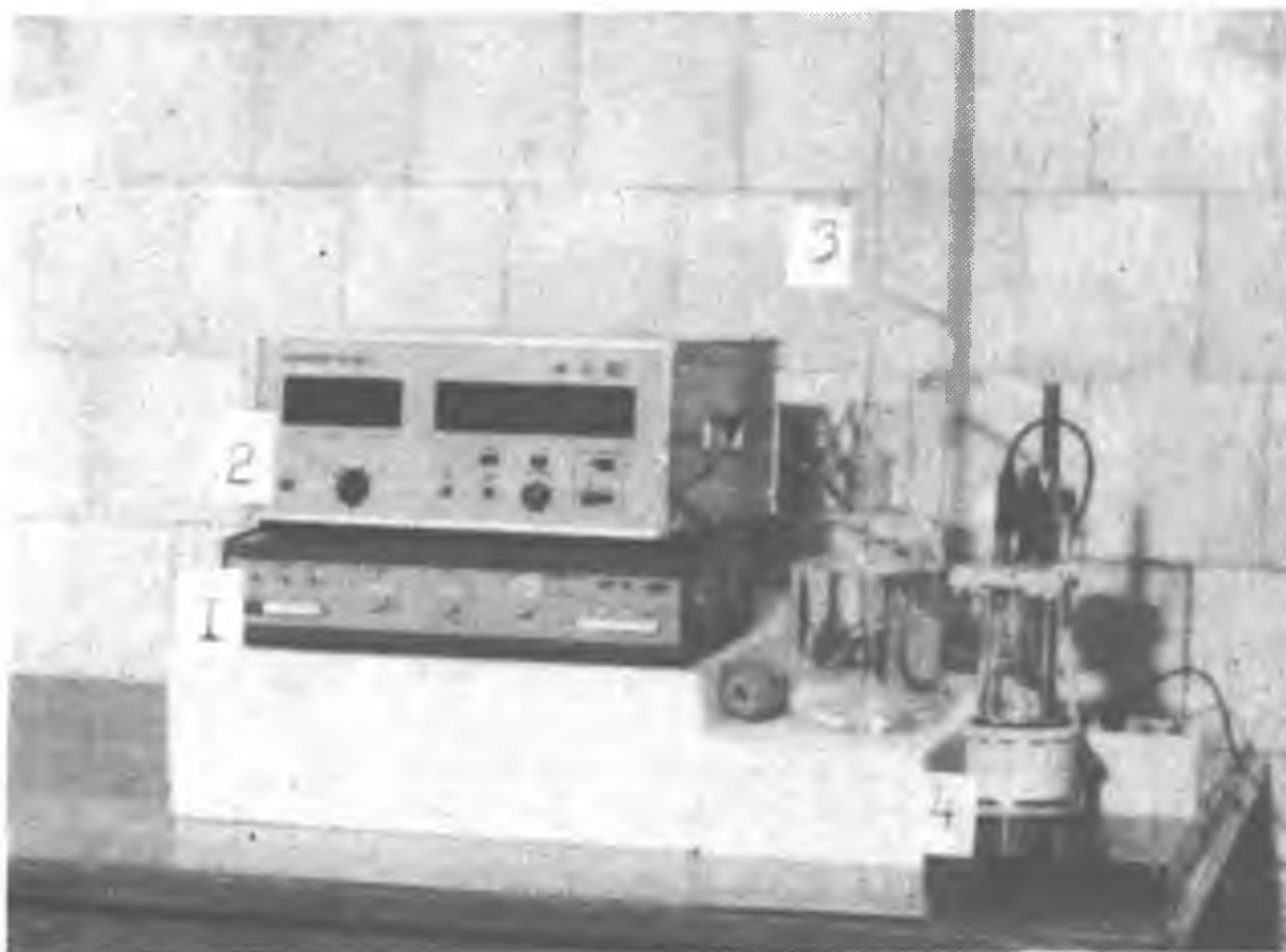
Установка для полуавтоматического потенциометрического титрования (ПАПТ) желудочного сока: 1--блок автоматического титрования БАТ-15; 2--ионномер И-130; 3--бюретка с автоматическим нулем; 4--магнитная мешалка.
