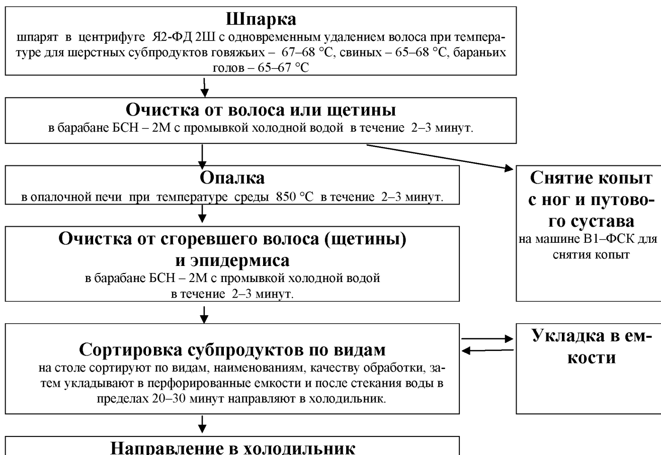
Рисунок 4 – Технологическая схема обработки шерстных субпродуктов
