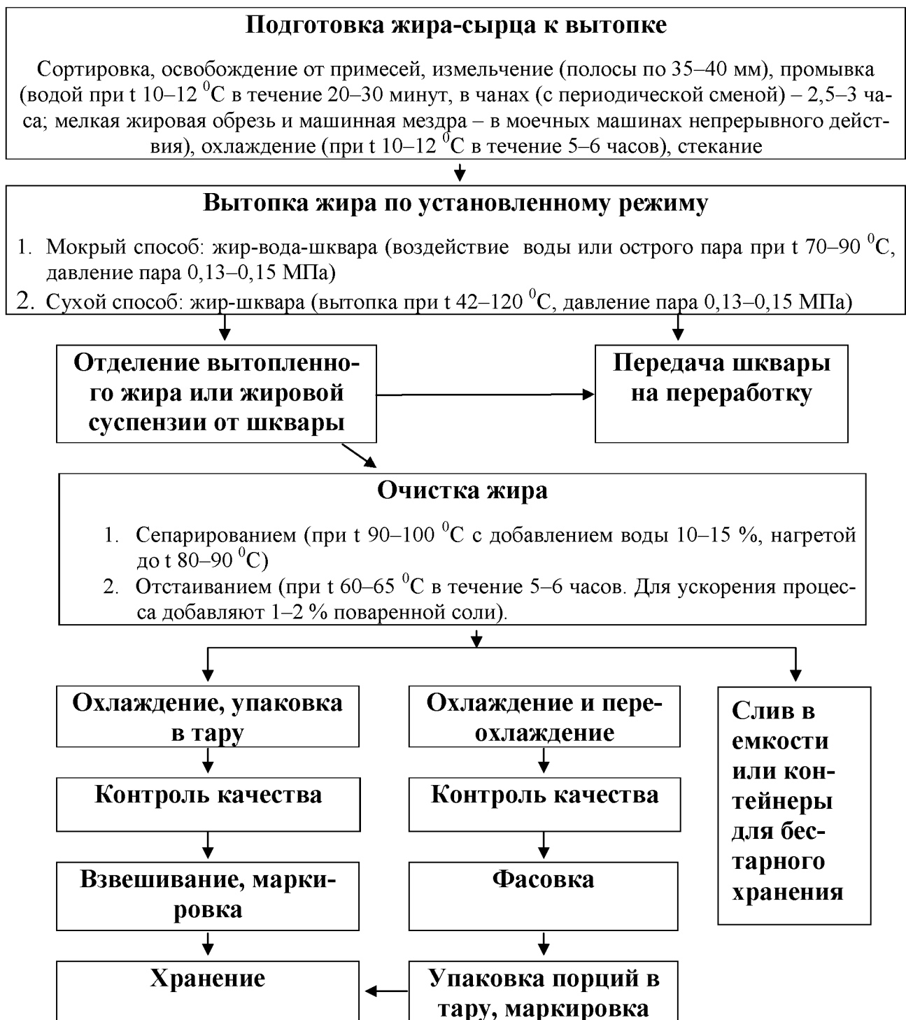
Рисунок 6 – Технологическая схема вытопки жира из мягкого жира-сырца
