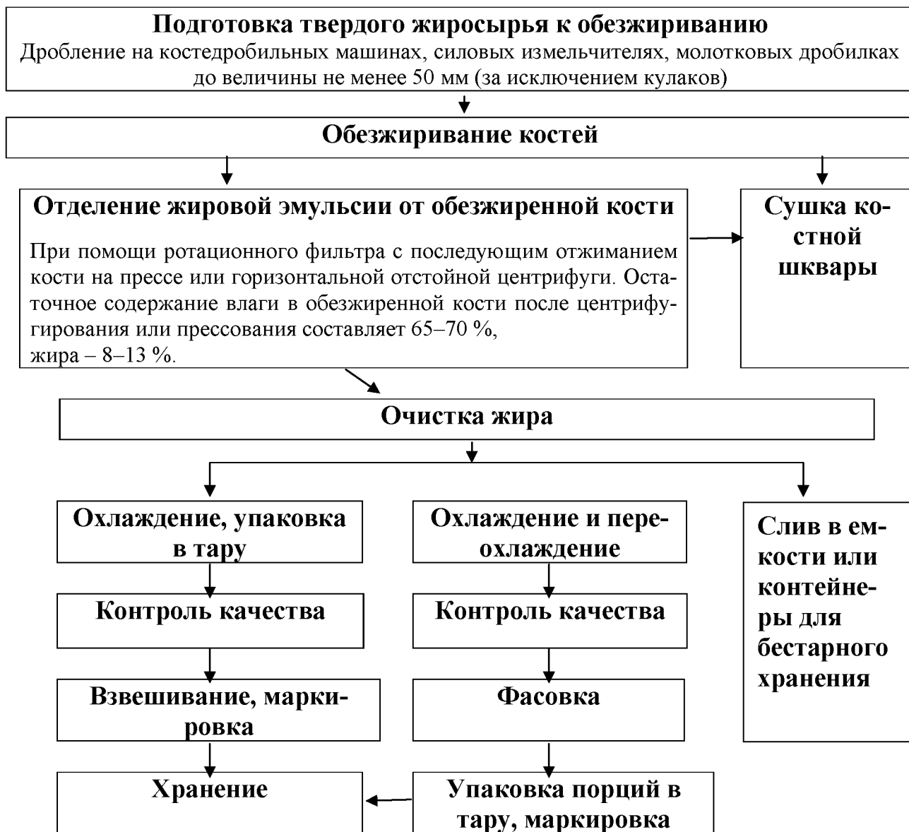
Рисунок 7 – Технологическая схема вытопки жира твердого жирсырья
