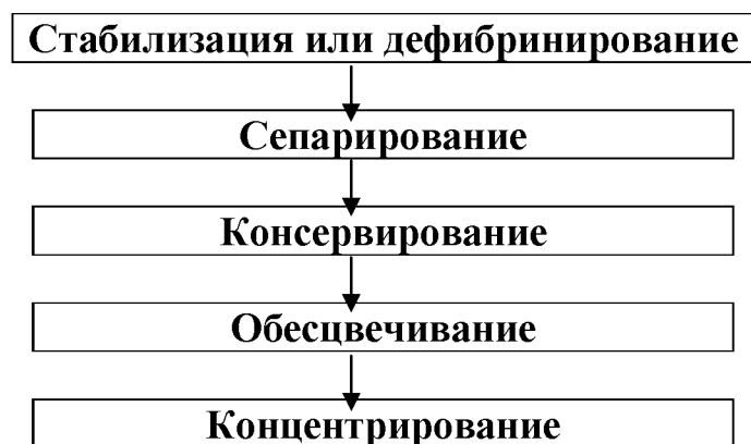
Рисунок 8 – Схема предварительной обработки крови
