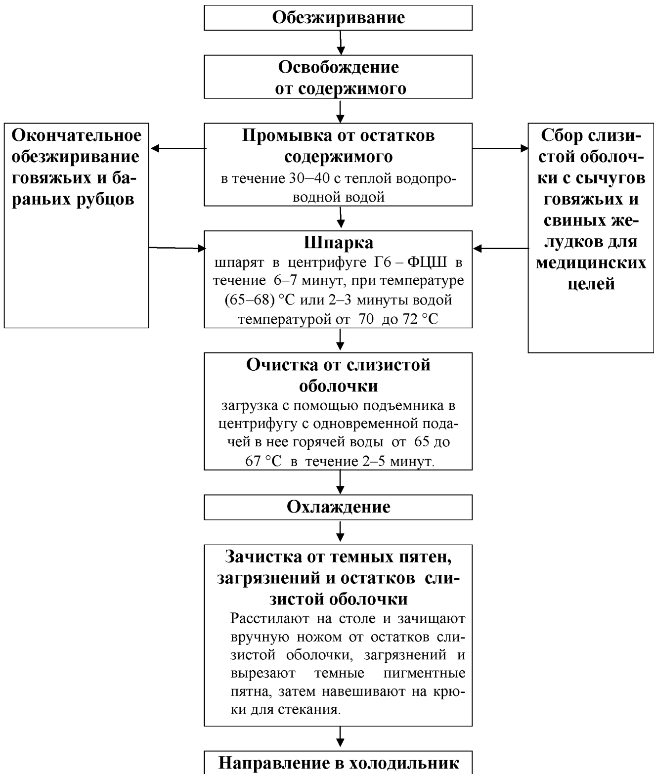
Рисунок 5 – Технологическая схема обработки слизистых субпродуктов
