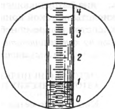
Рисунок 4 – Отсчет показаний жиромера
