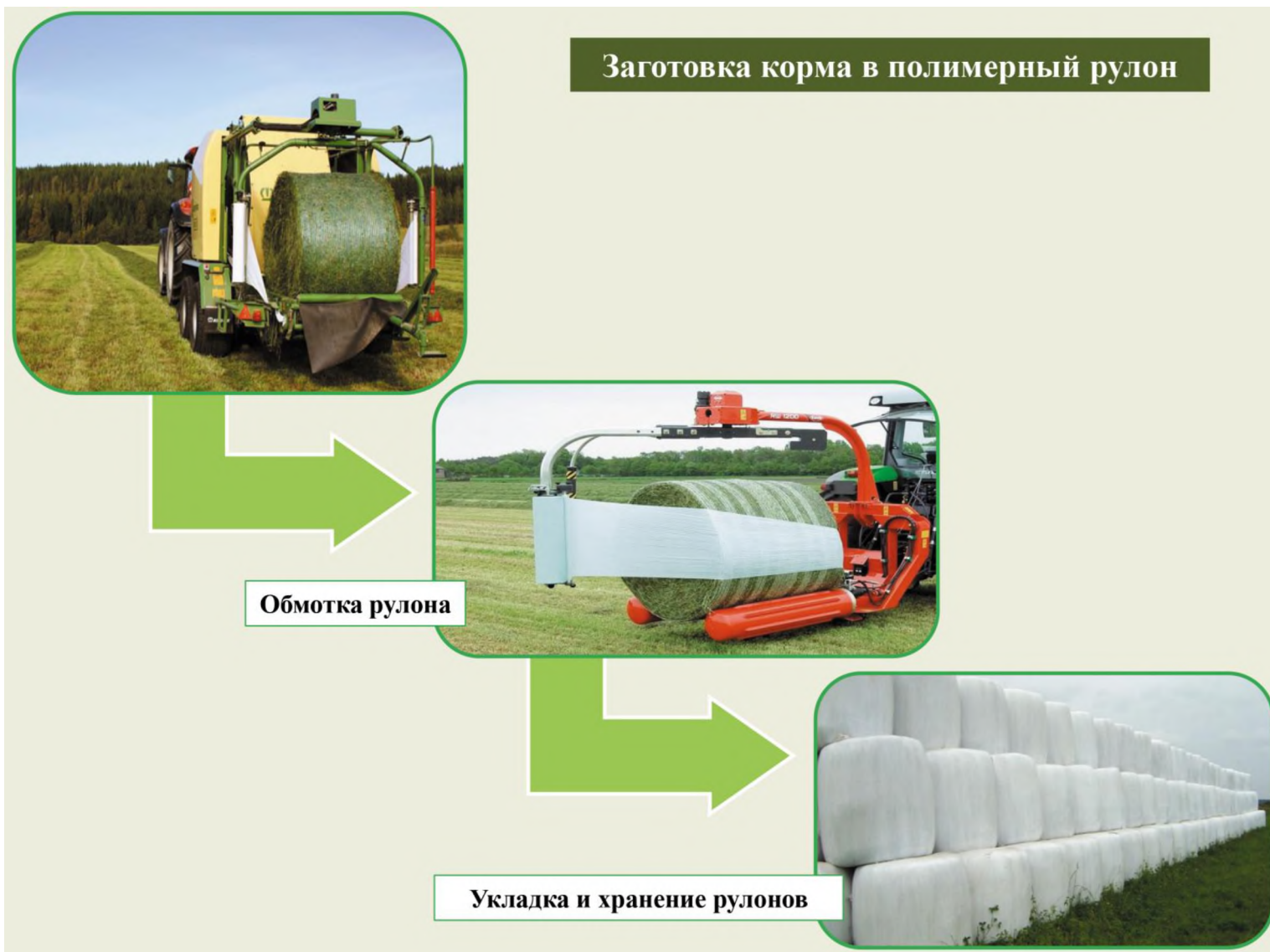
Рисунок 30 – Заготовка корма с обмоткой стрейч-пленкой каждого спрессованного рулона
