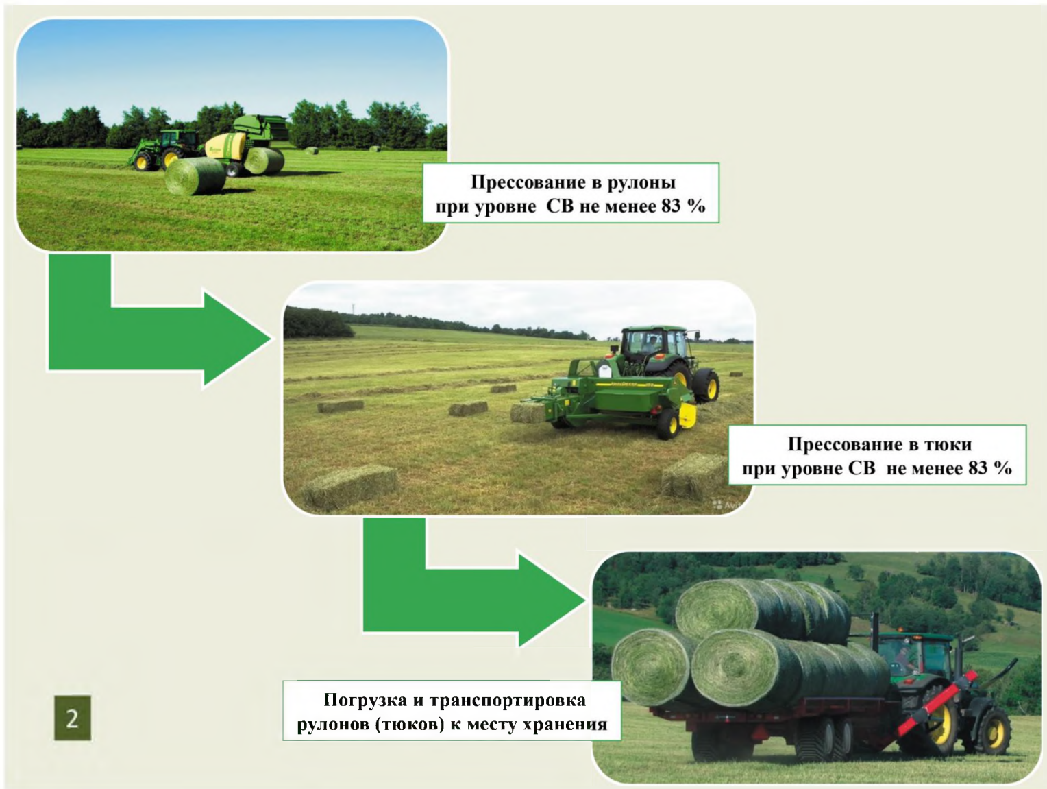
Рисунок 28 – Прессование сена в рулоны или тюки, погрузка и транспортировка
