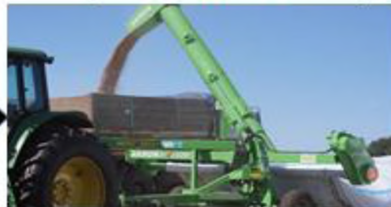
Выемка плющенного зерна из полимерного рукава с загрузкой в транспортное средство
