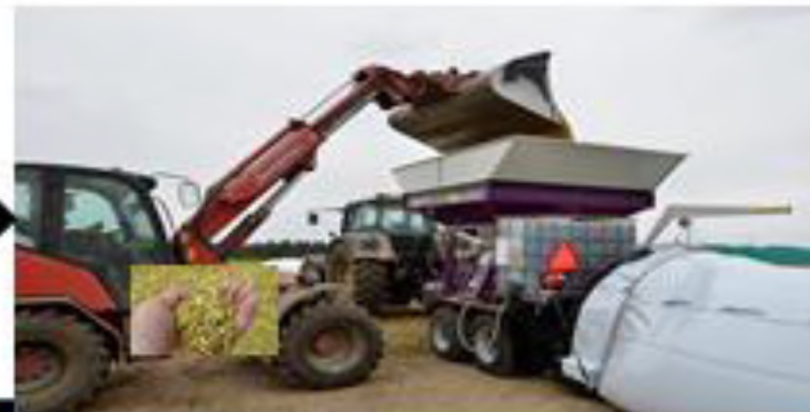
Плющение зерна с закладкой в полимерный рукав
