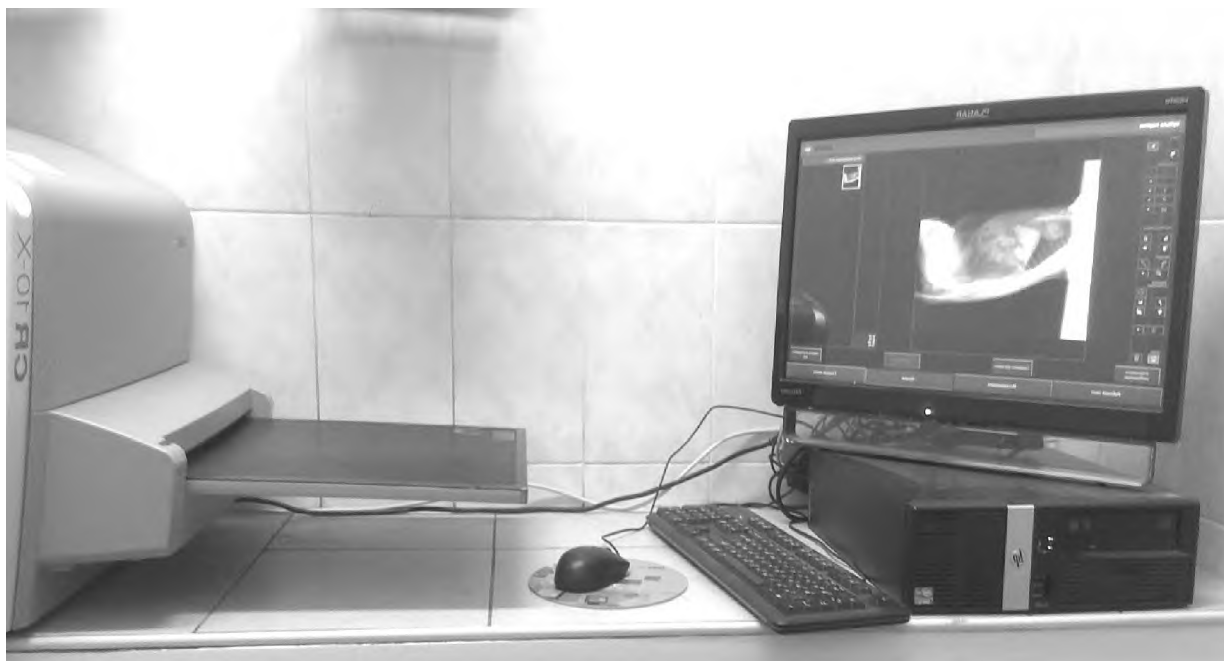
Рисунок 7 – Аппарат цифровой для диагностики и архивирования рентгеновских изображений модель CR10-X
