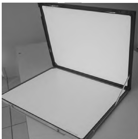
Рисунок 6 – Кассета (1) и рентгеновская пленка (2), которая помещается между двумя усиливающими экранами (3)
