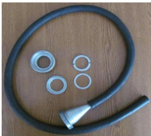
**Рисунок 15 – Металлический аллонж для отбора проб воздуха**
