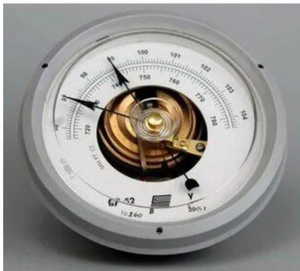
Рисунок 2 – Барометр-анероид
