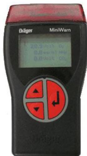
**Рисунок 11 – Многоканальный газоанализатор MiniWarn фирмы Dräger**
