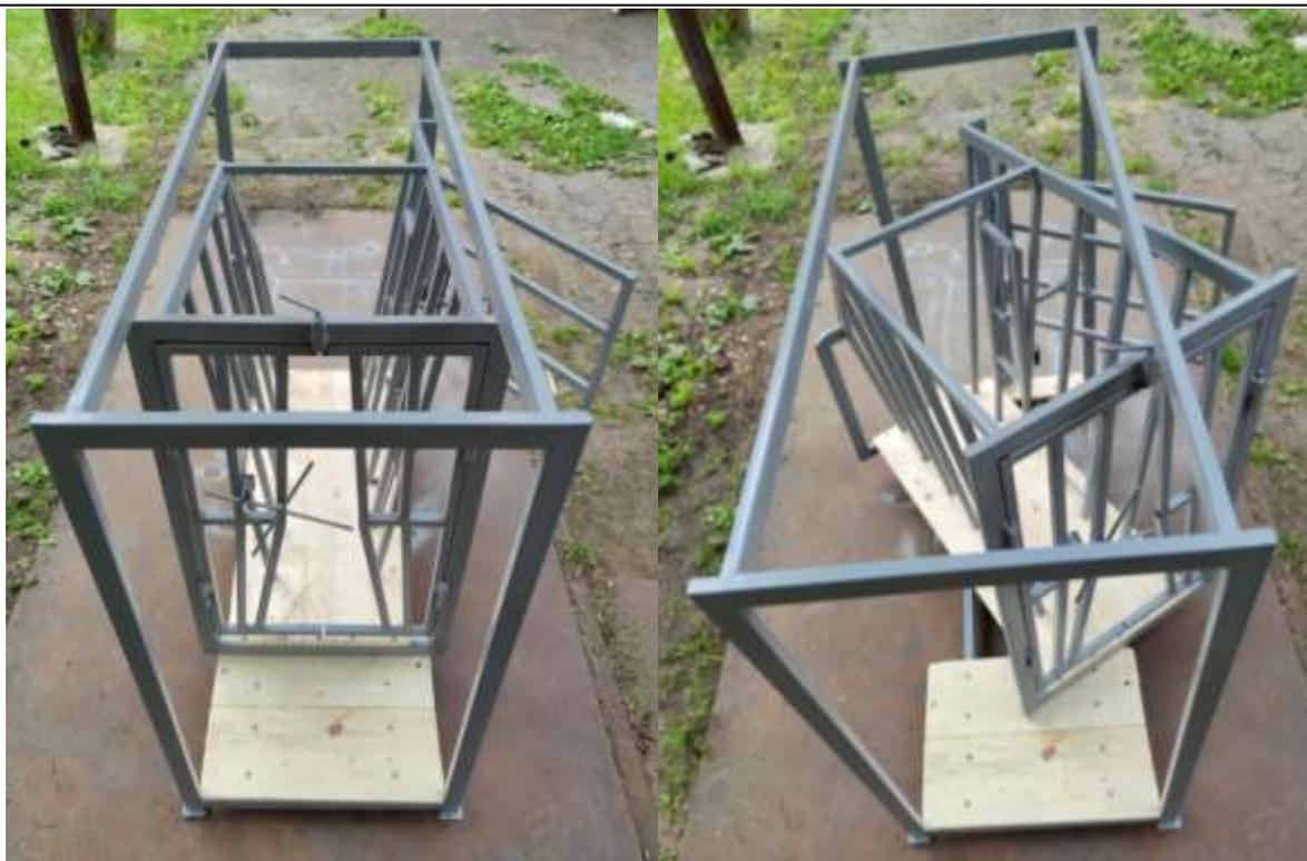
**Рисунок 1 – Поворотный станок для искусственного осеменения овец**
