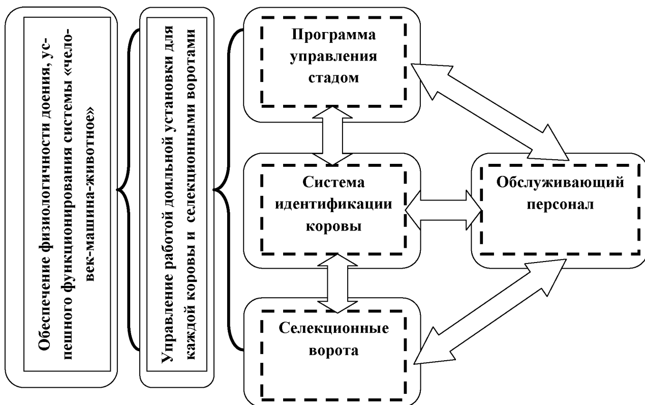
Рисунок 1 – Структурная схема взаимодействия отдельных элементов при автоматизации процесса доения
