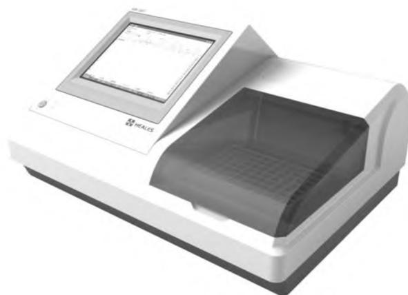
**Рисунок 2.4 – Автоматический спектрофотометр для учета ИФА**
