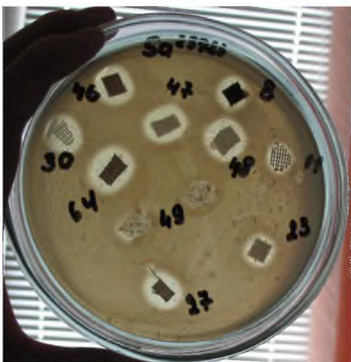
Рисунок 48 - Антимикробная активность образцов металлизированных тканей с напылением наночастиц меди
