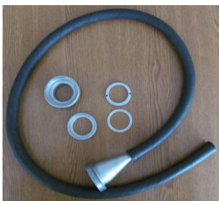
Рисунок 16 – Металлический аллонж для отбора проб воздуха
