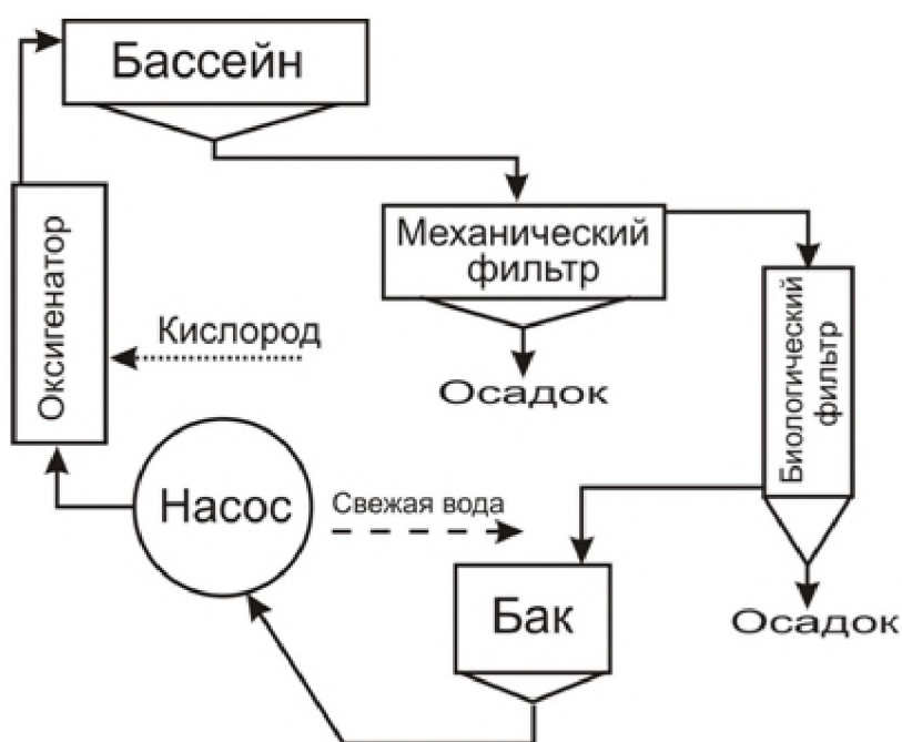
Рис. 68 – Схема очистки воды в рыбоводных водоемах
