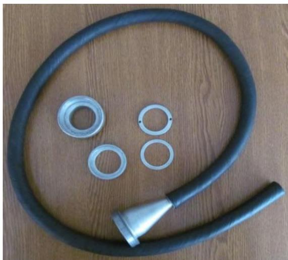
**Рисунок 13 – Металлический аллонж для отбора проб воздуха**
