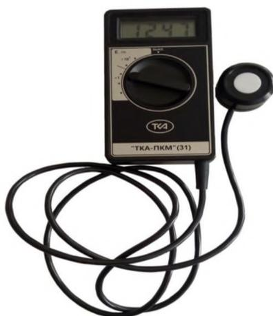
**Рисунок 10 – Люксометр ТКА-ПКМ 31**
