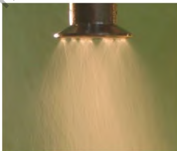
Рисунок 2 - Процесс ультразвуковой обработки воды излучателем
