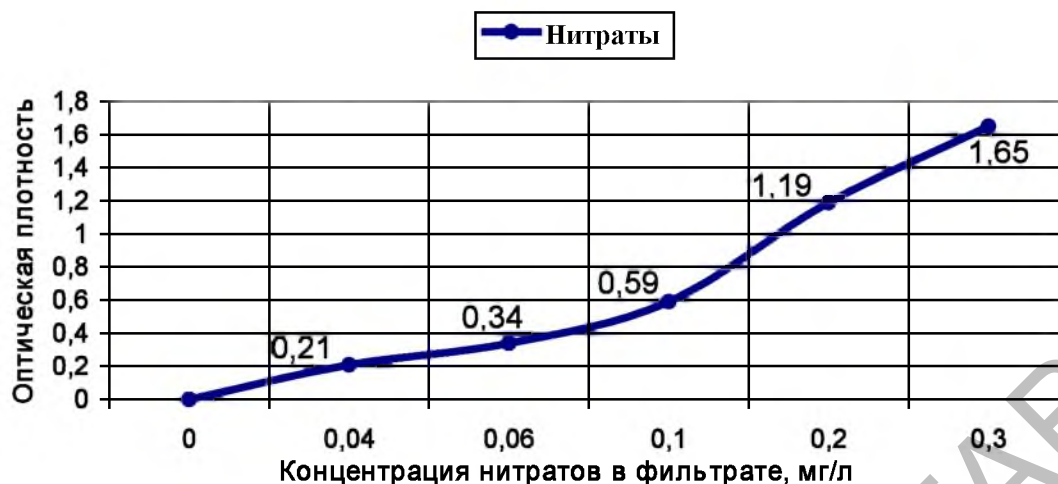
Рисунок 1 – Калибровочный график на нитраты (построен на основании собственных исследований авторов)
