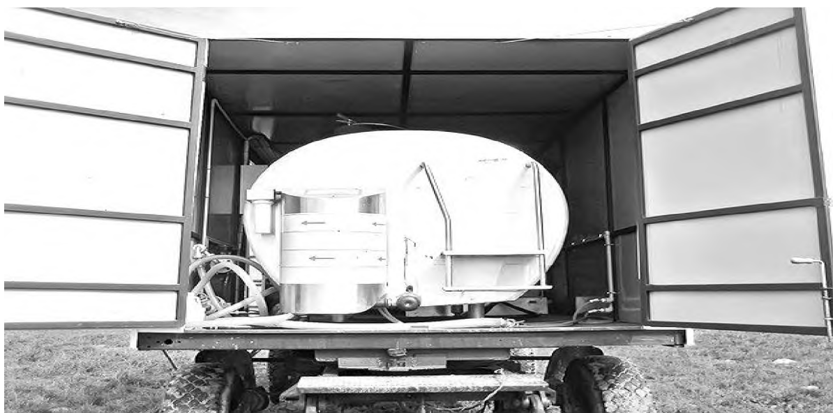
Рисунок 6 - Охладитель молока доильной установки УДП- 12 ( http://agriculture.by )
