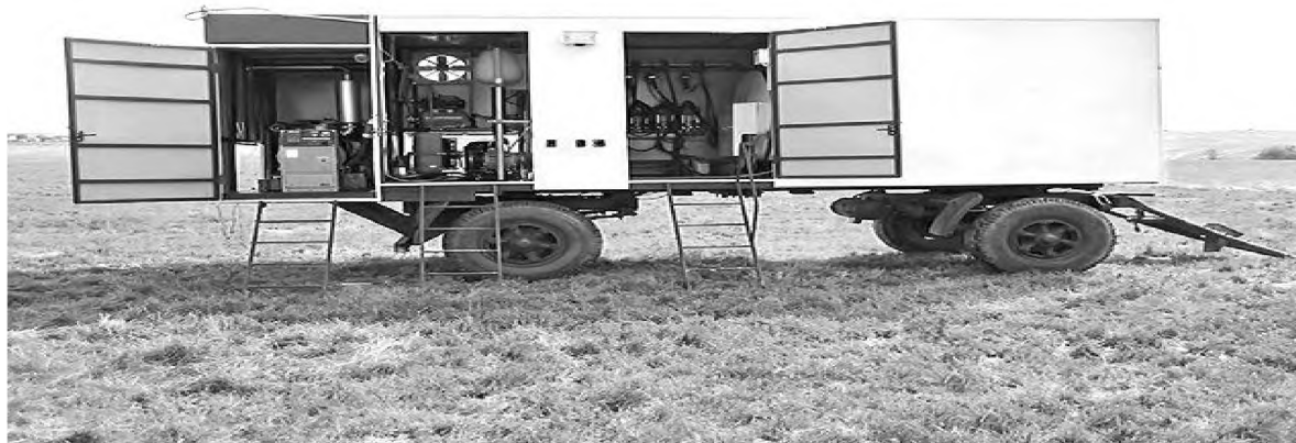
Рисунок 5 - Передвижная доильная установка УДП-12 ( http://agriculture.by )
