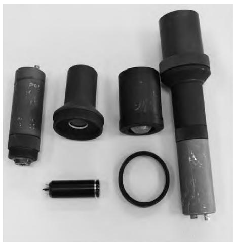
Сцинтилляционный детектор (в разобранном и собранном виде)
