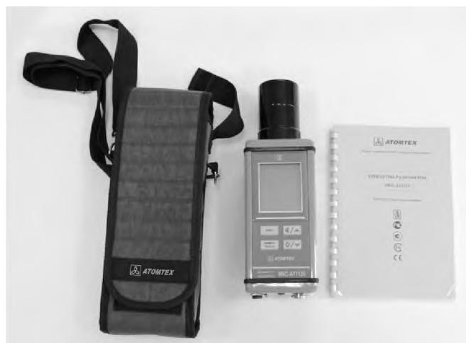
Дозиметр-радиометр МКС-АТ 1125
