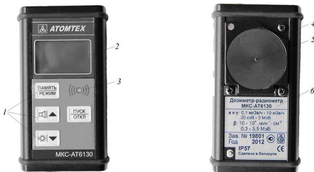
1 – мембранная панель управления; 2 – жидкокристаллический индикатор (ЖКИ);
