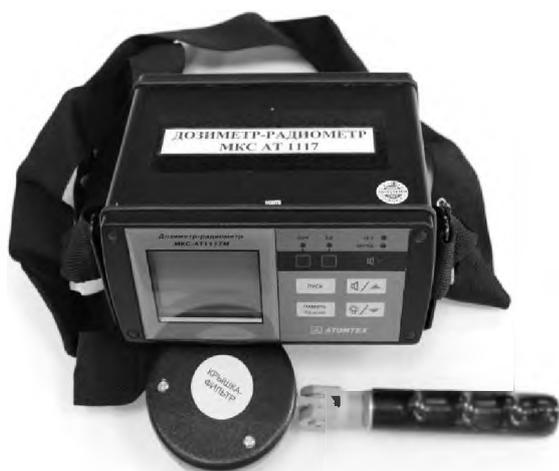
Дозиметр-радиометр МКС-АТ 1117
