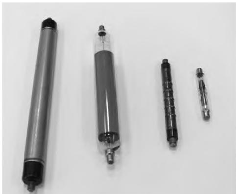
Газоразрядные счетчики горизонтального типа
