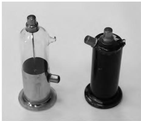
Газоразрядные счетчики торцевого типа
