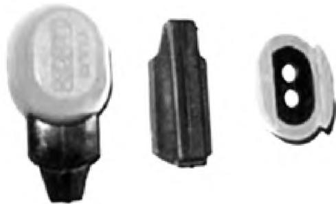
**Рисунок 5 – Термолюминесцентный дозиметр ДТУ-02**
