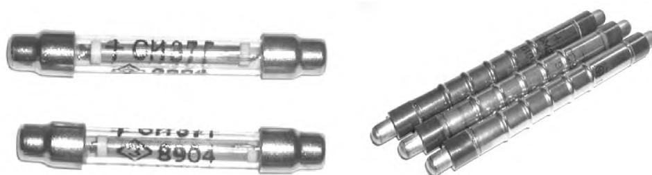
покрытой внутри тонким слоем металла (катод), и тонкой металлической нити – анод (рисунок 3). Стенки в основном изготавли-
