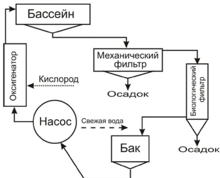
**Рис. 6 – Схема очистки воды в рыбоводных водоемах**
