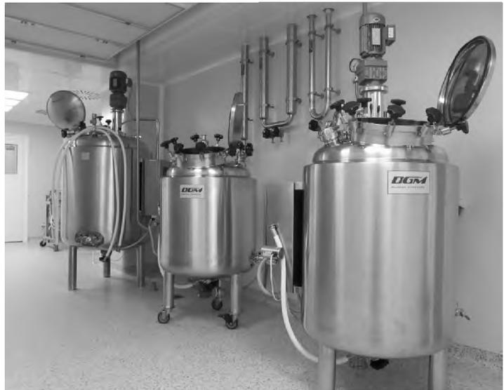
**Рисунок 19 - Реакторы для фильтрации питательных сред**
