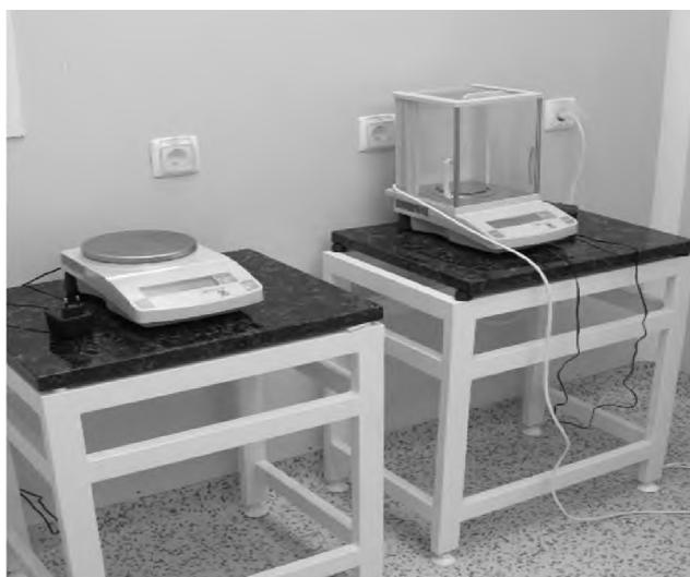
**Рисунок 16 - Аналитические весы для взвешивания компонентов**
