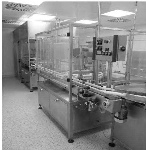
**Рисунок 21 - Линия разлива стерильных питательных сред**
