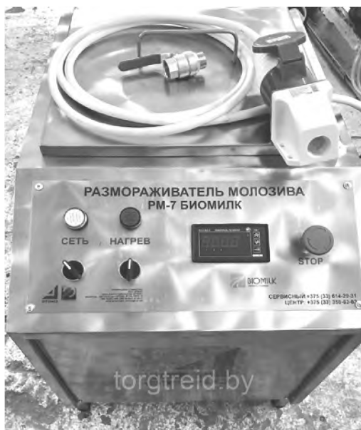
Рисунок 10 – Размораживатель молозива РМ-7 БИОМИЛК
