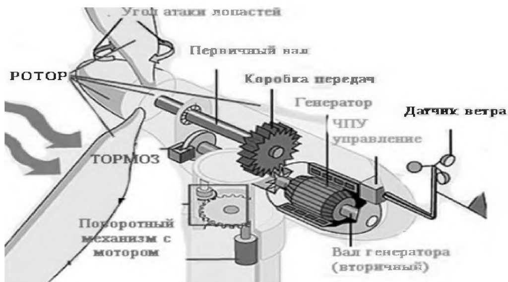
Рисунок 4 – Схема расположения типовых конструктивных элементов ВЭУ с горизонтальной осью вращения ВЭУ с вертикальной осью вращения
