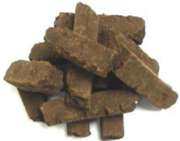
**Рисунок 2 – Образец брикетов, полученных после сушки помета**
