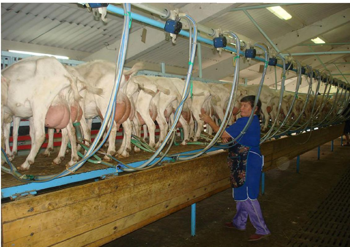
Рисунок 10 – Доильная установка для доения коз «Параллель» (*sacmilking.ru*)
