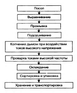
Дым в зону копчения подается из электрического дымогенератора. Копчение рыбы дымом происходит под воздействием постоянного тока высокого напряжения (40–60 кВ) в течение 3-6 мин. При этом в коптильной камере создается электрическое поле высокого напряжения, в котором частицы дыма под влиянием разности потенциалов движутся в строго определенном направлении и с большой скоростью осаждаются на поверхности рыбы, имеющей противоположный заряд.
