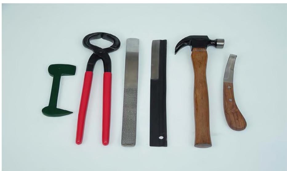
Рисунок 17 – Ковочный инструмент (обсекка, ковочные клещи, рашпиль, секач, ковочный молоток, копытный нож) ( https://nastanova.com )
