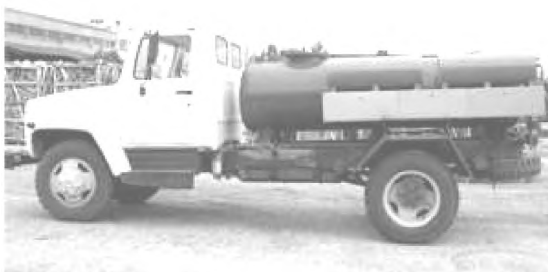
Рисунок 3 – Дезинфекционная установка Комарова ДУК-2 на шасси автомобилей ГАЗ
