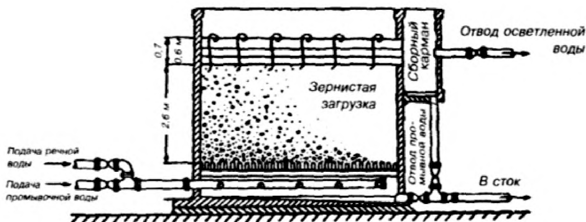
Рисунок 22 – Схема устройства контактного осветления
