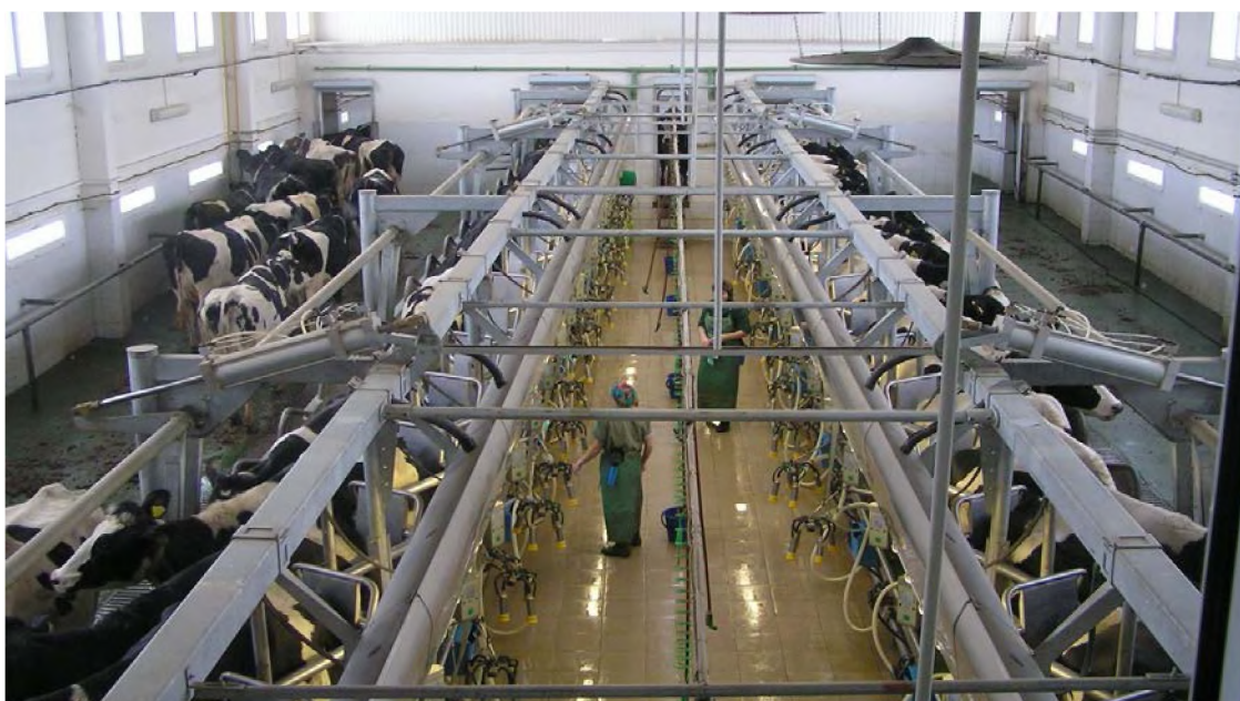
Рисунок 17 – Доильный зал «Елочка» 2х24 (вид сверху)
