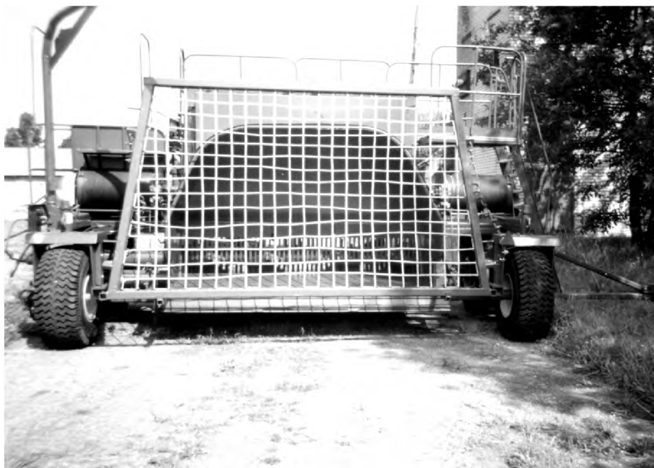
Рис. 5 – Упаковщик силосной массы УСМ–1 (вид спереди)
