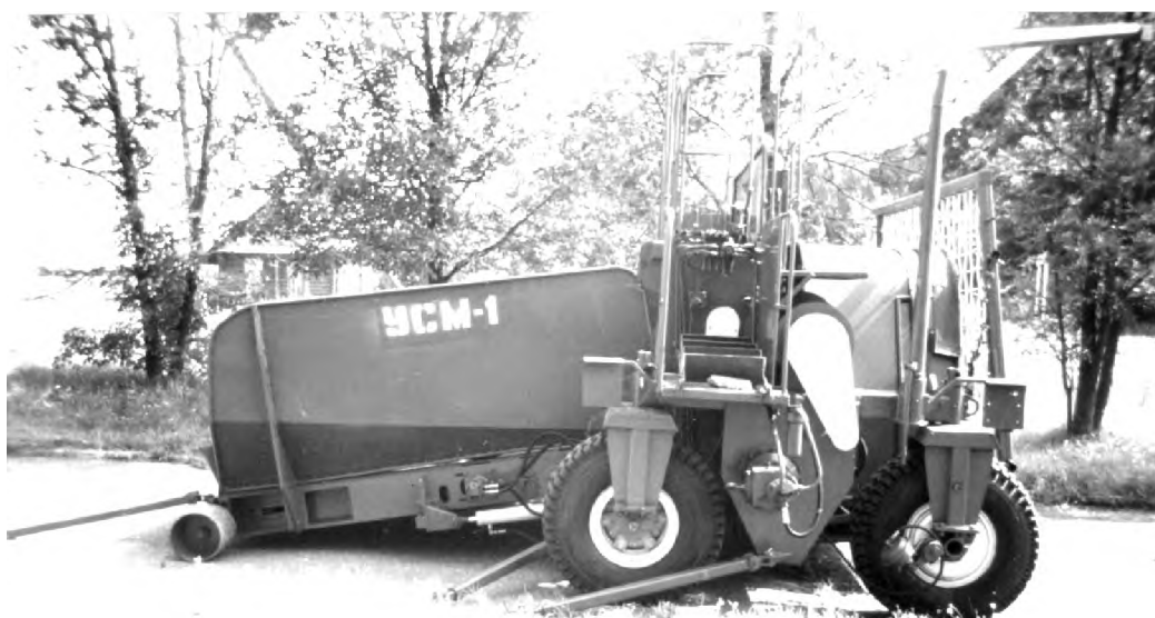
Рис. 4 – Упаковщик силосной массы УСМ–1 (вид сбоку)
