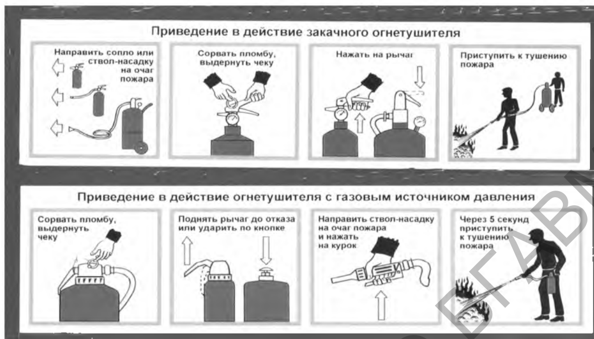
Рисунок 3 – Схема приведения в действие порошковых огнетушителей
