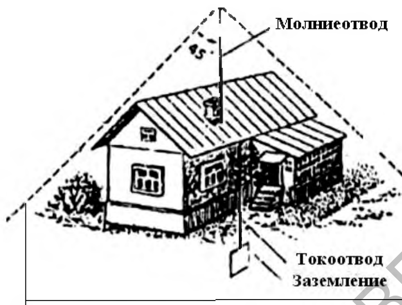
Зона защиты молниезащиты Рисунок 13 – Зона защиты молниезащиты
