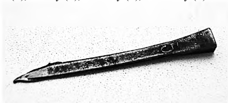
Рисунок 2 – Строение ковочного гвоздя (ухналя)
