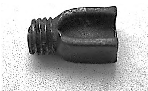
Рисунок 3 – Строение съемного шипа для подковы
