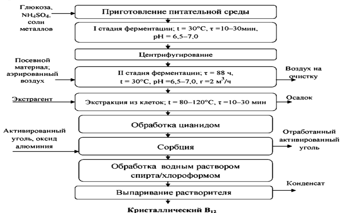
Рисунок 3.3 – Технологическая схема получения витамина B 12 путем микробиологического синтеза с помощью пропионовокислых бактерий [Разговоров, П.Б., 2010]
