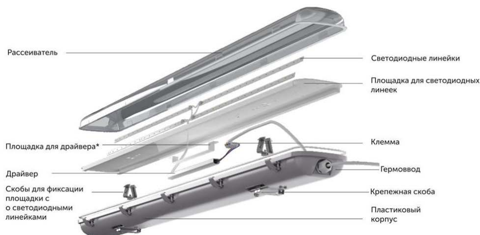
Рисунок 13– Конструкция светильника светодиодного ЛСП серии Standart 10
