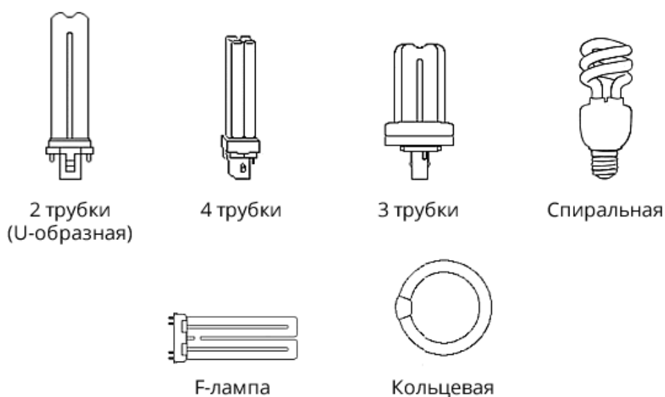
Рисунок 10 – Формы трубок компактных люминесцентных ламп 8
