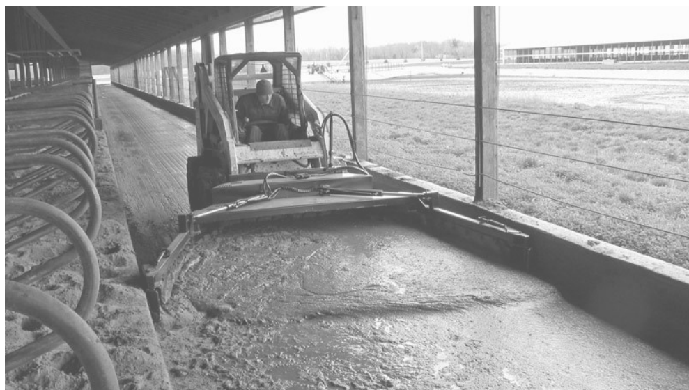
Рисунок 7 – Скребок-толкатель для навоза
