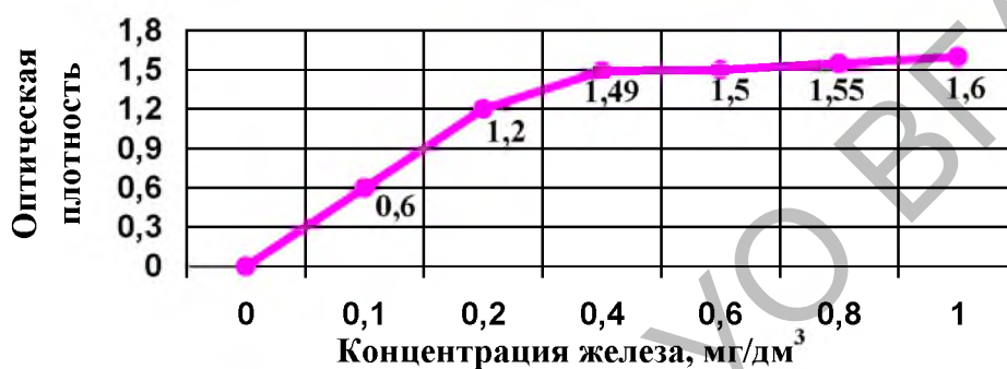
Рисунок 6 – Калибровочный график для определения железа в воде (построен на основании собственных исследований авторов пособия)
